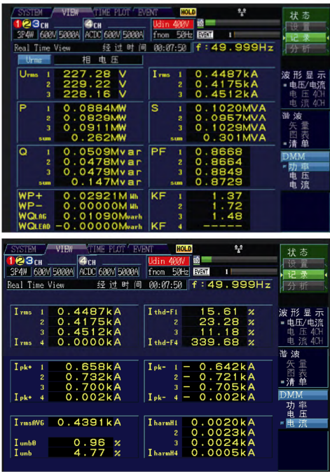
图 8 无功补偿综合控制装置投入前的电能质量
